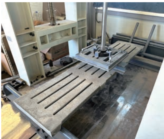
▲ KCC콘크리트가 개발한 신형 콘슬라트의 압축강도와 휨하중강도 테스트 모습
